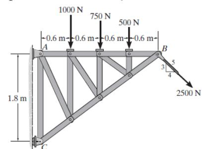
Resposta:  $F = 4.250 \text{ N}$   $\nabla 61,93^\circ$  com  $M = -9.600 \text{ N.m}$
