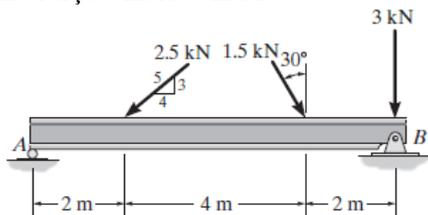
Resposta:  $F = 5,932 \text{ kN}$   $\nabla 77,838^\circ$  com  $M = - 34,794 \text{ kN.m}$
