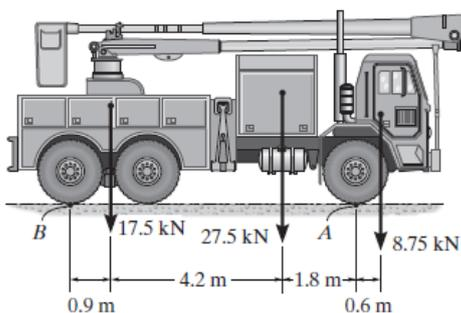
Resposta:  $F = 53,75 \text{ kN}$  a  $4,123 \text{ m}$  à direita de  $B$
